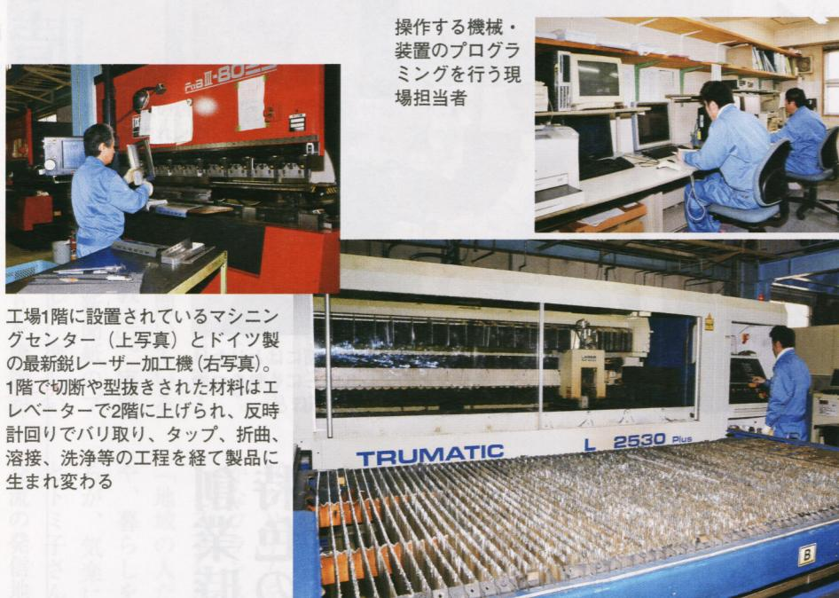
工場1階に設置されているマシンセンター(上写真)とドイツ製の最新鋭レーザー加工機(右写真)。1階で切断や型抜きされた材料はエレベーターで2階に上げられ、反時計回りでバリ取り、タップ、折曲、溶接、洗浄等の工程を経て製品に生まれ変わる
