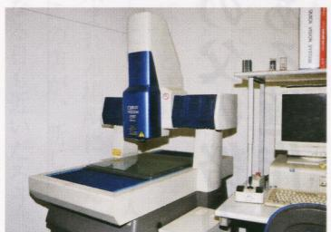
非接触の二次元測定器で検査。
