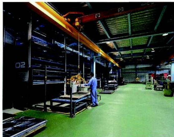
CSから自走台車で出庫し、天井クレーンで加工機（右）へ供給する。
